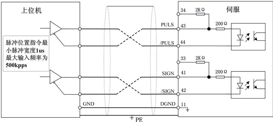
图2-10 差分脉冲指令输入接线图
