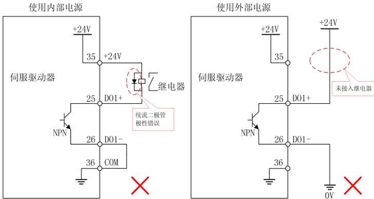
图 2-19 数字量输出端子连接继电器时错误接线
