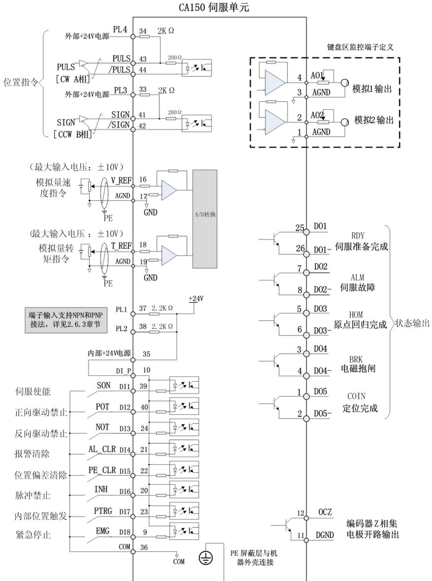
图 2-9 位置、速度、转矩控制接线图
