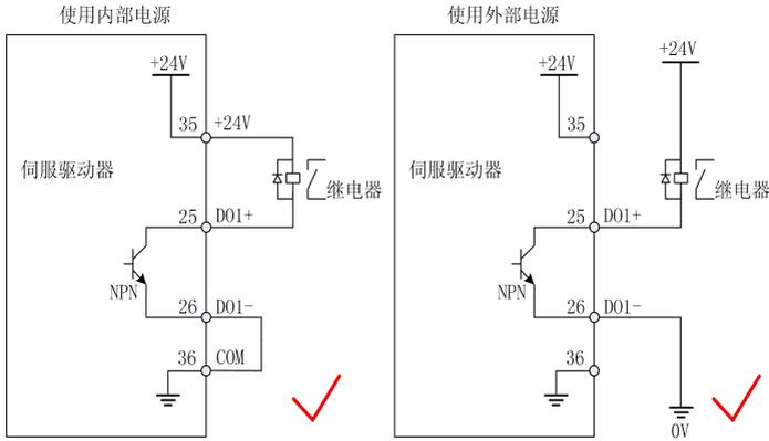
图 2-18 数字量输出端子连接继电器时正确接线
